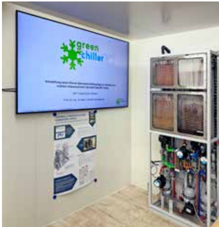
Demonstrator 1 kW Wasser-Lithiumbromid Absorptionskälte-Anlage im SorptionTakeOff Trailer.
