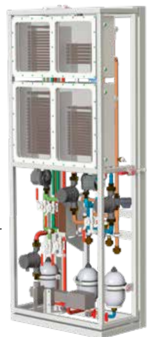
Demonstrator von vorne mit Plexiglasscheiben vor den vier Hauptkomponenten zur visuellen Ansicht der internen Sorptionsprozesse.
