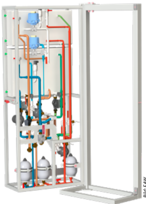
Demonstrator geöffnet mit Rückansicht zur Darstellung der Verbindungsleitungen der einzelnen Komponenten.
