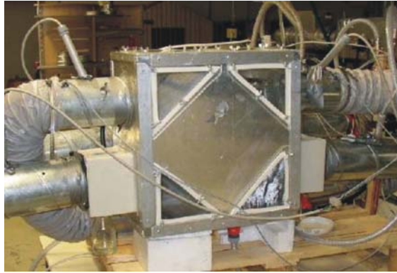
Abb. 9. Aufbau der Wärmetauscherabsorptionseinheit WTAH der Flüssigsorption (Quelle: zafh.net)
