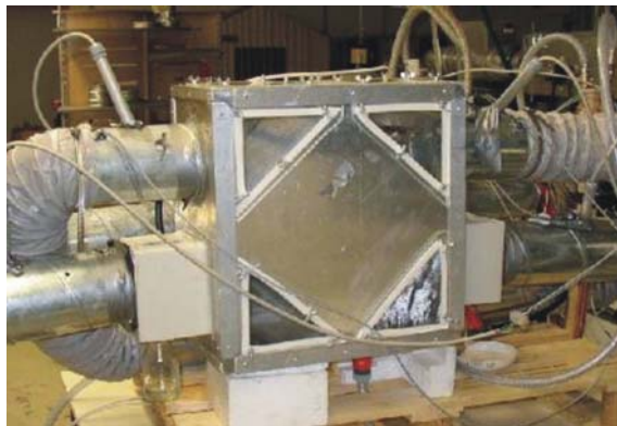
Abb. 5. Aufbau der Wärmetauscherabsorptionseinheit WTAH der Flüssigsorption (Quelle: zafh.net)
